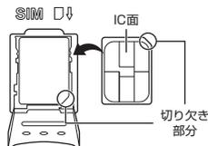
④ カードカバーを閉じ、カードロックを押し上げてロックします。
