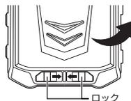
② SIMカードカバーを下に押し、カードロックを開けカードカバーを持ち上げます。
