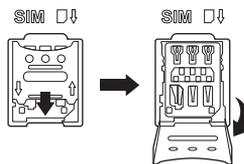
③ SIMカードの基板側を下向きにしカードトレイに乗せます。
